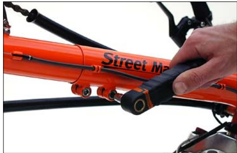
Lösen der Klemmschrauben zum Verstellen des Tretlagerauslegers.
