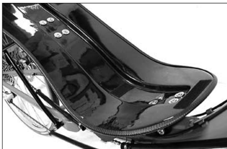
Der Sitz ist im Bereich der Rückenwirbel mit einer Vertiefung versehen. Hier können Sie die Polsterung individuell anpassen.
