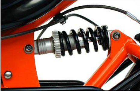
Federerelement DNM DV-22 Durch das Drehen des Einstellringes am vorderen Ende der Feder stellen Sie die Federvorspannung ein.
